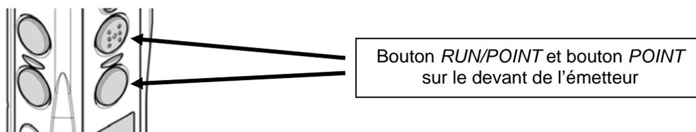
4. Maintenez le bouton *RUN/POINT* et le bouton *POINT* situé sur l'avant de l'émetteur appuyé simultanément pendant 3 secondes, ou jusqu'à ce que le voyant LED du collier-récepteur clignote plus lentement.
