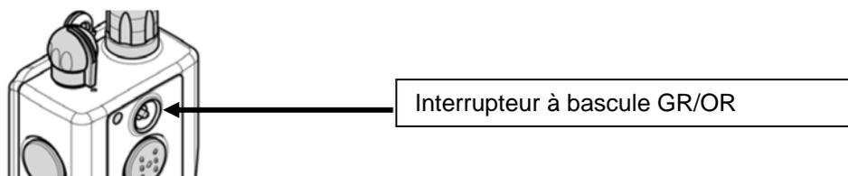
1. Commencer l'initialisation avec l'émetteur étant allumé et le collier-récepteur éteint. Sur le devant de l'émetteur se trouve l'interrupteur à bascule **GR/OR**. Positionner cet interrupteur sur "**GR**" pour initialiser le collier-récepteur **VERT**. Positionner l'interrupteur sur "**OR**" pour initialiser le collier-récepteur **ORANGE**.
