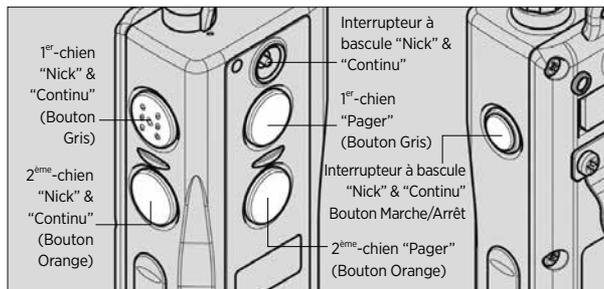
Le Dogtra 3500NCP Super-X Series a cinq boutons et un interrupteur à bascule (Deux sur la face avant de l'émetteur, deux sur le côté gauche, et un sur le côté droit).
