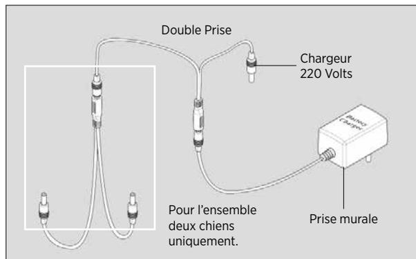
Le chargeur de batterie et la double prise permettent de recharger simultanément l'émetteur et le récepteur. Le chargeur de batterie fonctionne sur 220 Volts. Un chargeur 10 Volts pour automobile est aussi disponible.
