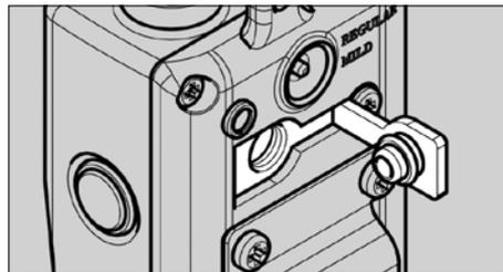
**La prise jack pour chargeur de batterie de l'émetteur.**
